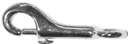
Brak śladów zużycia zaczepu
