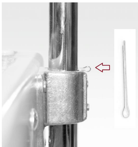
Zawlecзка - przed i po wyciągnięciu z ramy
