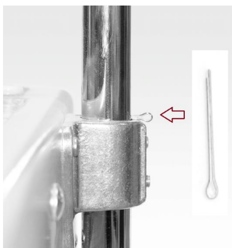
Zawlecзка - przed i po wyciągnięciu z ramy
