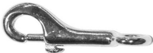
Brak śladów zużycia zaczepu
