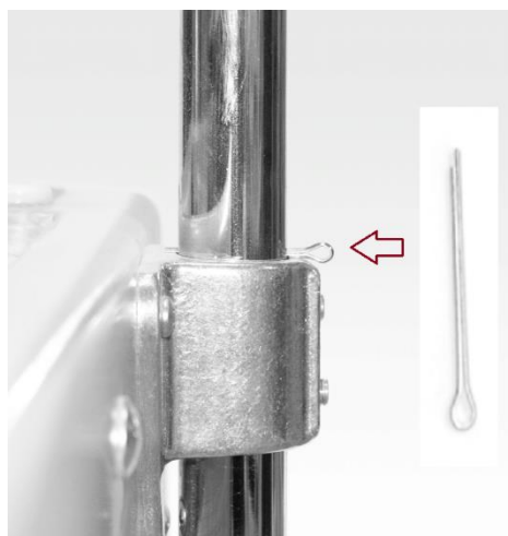
Zawlecзка - przed i po wyciągnięciu z ramy
