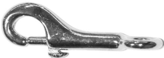
Brak śladów zużycia zaczepu
